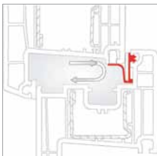
Pieaugot vēja spiedienam, AirComfort sistēma automātiski noslēdzas pēc Bernulli principa
